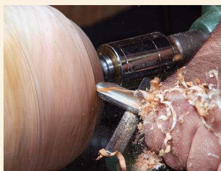
Un corte de pretorneado en la parte de afuera de un tazón.
