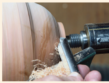
Un corte de tirar (Pull Cut) es usado para entrar a un lugar ajustado para limpiar el grano roto. Para un corte mejor, un corte rasurado (shear cut) rote la herramienta levemente en el sentido de las agujas del reloj y baje la manija.
