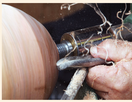
Un toque ligero y un borde afilado producirá virutas finas y una superficie limpiamente cortada en el fuera de un tazón.
