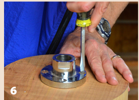
Use tornillos bien robustos para atornillar el plato de tornillos al bloque.
