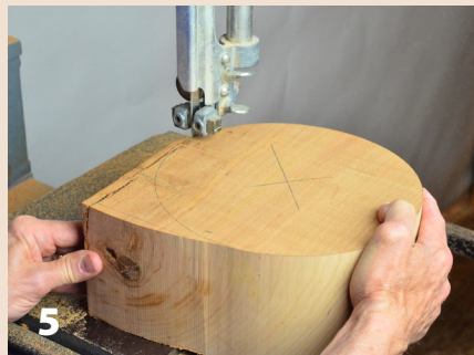
Cortando el bloque con el sinfín remueve un 25 % de la masa original.
