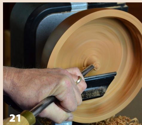
21 La gubia pequeña de cuencos corta a través de la protuberancia del centro de la madera que ha soportado el contrapunto.
