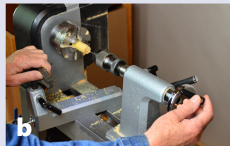
b Haga un agujero en el mandril mientras todavía está en el torno. Así se asegura que el clavo estará bien centrado
