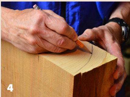
Ted estudia el bloque y decide seguir los anillos de crecimiento de la madera para hacer la línea del cuenco. Está tratando por una curva catenaria, la forma que da una cadena colgando y también el famoso arco de la ciudad de Saint Louis
