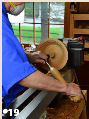
19 Con el contrapunto fuera de camino, Ted puede desplazar el mango de la gubia de cuenco muy abierta por encima de la cama del torno para cortar madera de las paredes del cuenco.
