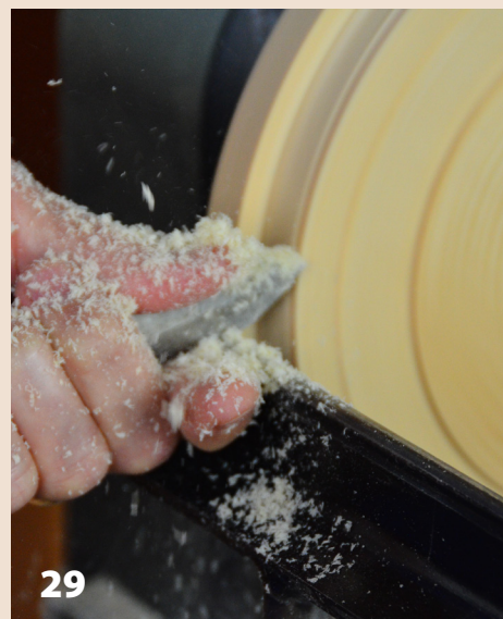
Dar forma al file del cepo donde se montara el borde del cuenco.
