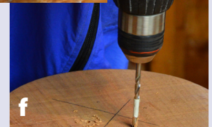
f Un trocito de cinta adhesiva ayuda a marcar en la broca la profundidad necesaria para los agujeros piloto donde atornillar el plato.
