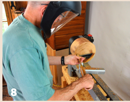
8 El pequeño raspador redondo aplanar la cara del cuenco. La mano izquierda sostiene la herramienta firme en el apoyo de herramientas y la guía transversalmente deslizándola a través del apoyo de herramientas. La mano derecha estabiliza la herramienta y empuja el corte. El raspador está horizontal y la dirección del corte es de derecha a la izquierda, o del centro hacia el borde. Ted usó el contrapunto para un mejor soporte, pero lo removió para los últimos cortes de la cara...
