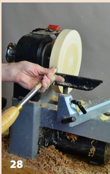
El cepo es un disco de madera suave nivelado un poco más grande que el diámetro del cuenco.
