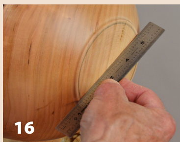
16 Una regla muestra si el pie está nivelado.
