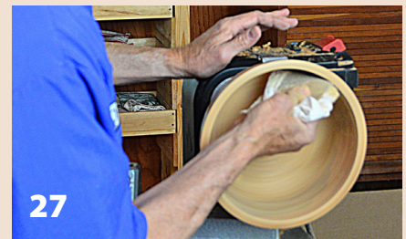
Ted corta planchas de abrasivo en tiras y las dobla en 3 para tener 3 superficies frescas de acabado. Cambiando la dirección del torno hacia adelante a reversa, él mantiene los abrasivos moviéndose a través de la superficie. El papel toalla doblado cubre los abrasivos y protege sus dedos del calor que causa la fricción.
