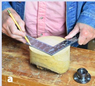
a Con la esquina de la escuadra en el borde del bloque, marque los puntos donde los brazos cruzan el borde del bloque. La línea que une estos dos puntos es un diámetro del bloque
