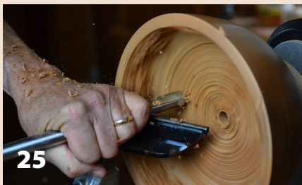
La profundidad del hueco indica el fondo de adentro del cuenco. El apoyo de herramientas se coloca en ángulo lo más cerca al corte posible.
