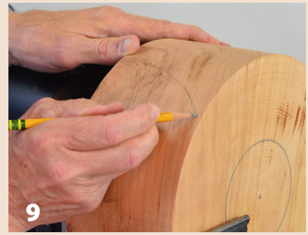
9 Con el bloque ya redondeado y balanceado, Ted detiene el torno y marca la línea del pie. También marca el perfil del cuenco en el bloque para poder visualizar la madera que tiene que remover.
