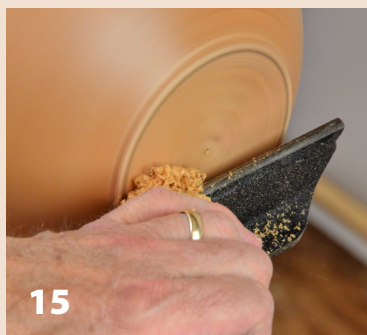
15 El raspador largo nivela el pie del cuenco.
