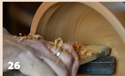
El raspador grande empareja la madera y deja una superficie suave. La masa del raspador ayuda a amortiguar la vibración que causa el grano desgarrado de fibras.
