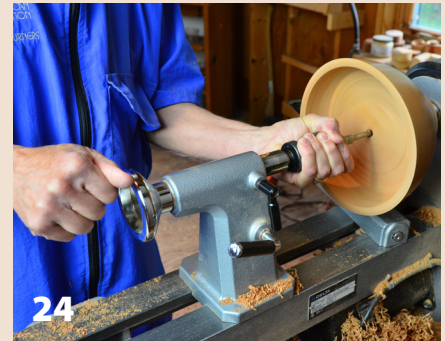
El cañón del contrapunto avanza la broca en la madera rotando. El proceso necesita la ayuda de una mano agarrando el mandril para mantenerlo estable.
