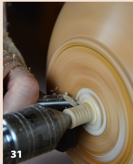
Desbaste el bloque encolado del pie del cuenco, dejando la contrapunta en el lugar la mayor parte del tiempo posible.
