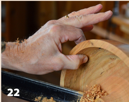
Ted verifica el grosor de las paredes con sus dedos y hace que las paredes de cuenco sean suaves con cortes muy finos antes de proceder el vaciado profundo.
