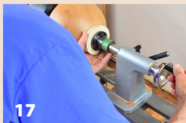
17 Cubra con cola ambas superficies y use el contrapunto para centrar y agarrar el bloque al cuenco.
