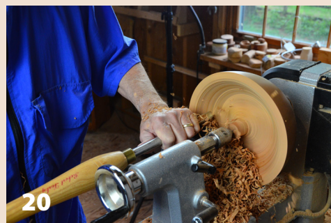
20 La gubia de cuencos remueve mucha madera apresuradamente, pero muy pronto no va a poder llegar a las paredes del cuenco porque el contrapunto estará en el camino.
