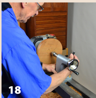
18 Remontar el cuenco enroscando el pedazo de bloque encolado al plato de tornillos en el cabezal. Para seguridad, se trae el contrapunto como soporte extra.
