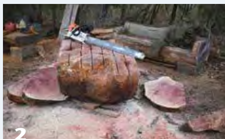
2 Una cadena afilada asegura cortes rectos el resto del camino. Las losas se cortan a cada lado en forma alterna para mantener el trabajo equilibrado.
