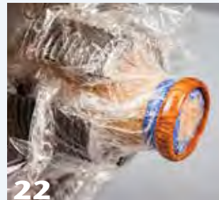
La envoltura de plástico evita que el anillo se atasque en el mandril durante el acabado.
