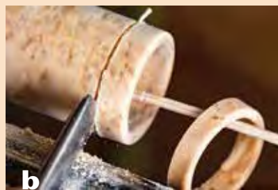
El autor tornea y ahueca un cilindro de nudos, luego separa múltiples anillos. Una espiga delgada sostenida en el cilindro atrapa los anillos a medida que se desprenden.
