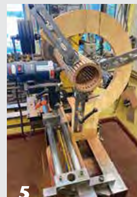
Una fresadora sirve como cortador. El cilindro está ranurado y ahuecado.
