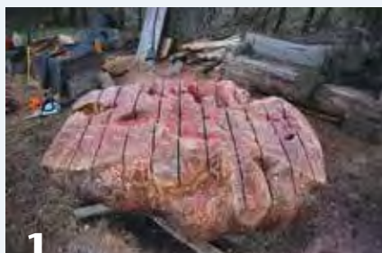
1 Con el nudo del tocón boca abajo, el autor coloca las losas y corta solo una parte del camino.
