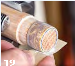
19 El exterior del anillo se gira, se lija y se parte a un ancho personalizado.
