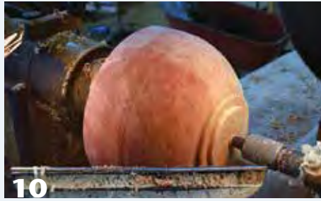
10 El perfil exterior se moldea con una gubia de cuenco. Tenga en cuenta la espiga de sujeción en el pie. Dado que este proyecto implica el procesamiento por lotes, varios tazones se vuelven a esta etapa antes de continuar.
