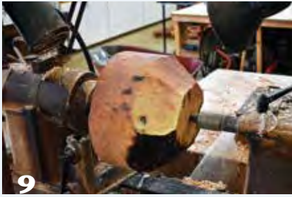
9 La mitad inferior de esta pieza en bruto se modeló en bruto con una motosierra eléctrica para mejorar aún más su equilibrio en el torno.
