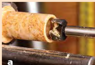
El autor tornea y ahueca un cilindro de nudos, luego separa múltiples anillos. Una espiga delgada sostenida en el cilindro atrapa los anillos a medida que se desprenden.
