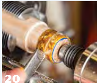
19 El exterior del anillo se gira, se lija y se parte a un ancho personalizado.
