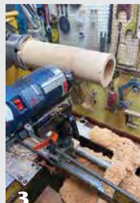
Una fresadora sirve como cortador. El cilindro está ranurado y ahuecado.
