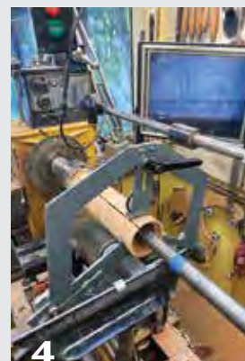
Una fresadora sirve como cortador. El cilindro está ranurado y ahuecado.
