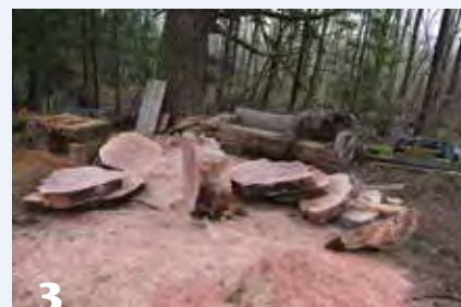
2 Una cadena afilada asegura cortes rectos el resto del camino. Las losas se cortan a cada lado en forma alterna para mantener el trabajo equilibrado.
